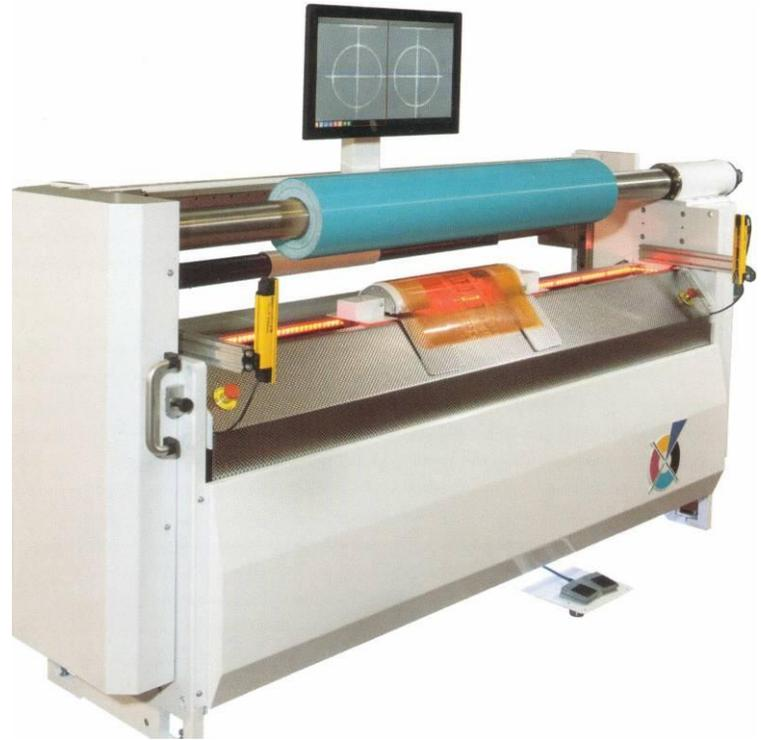
La configurazione del Sistema Automounter è un approccio radicalmente innovativo se paragonato ai sistemi tradizionali che prevedono le telecamere posizionate sopra il mandrino e la manipolazione della lastra anch'essa dall'alto verso il basso.
