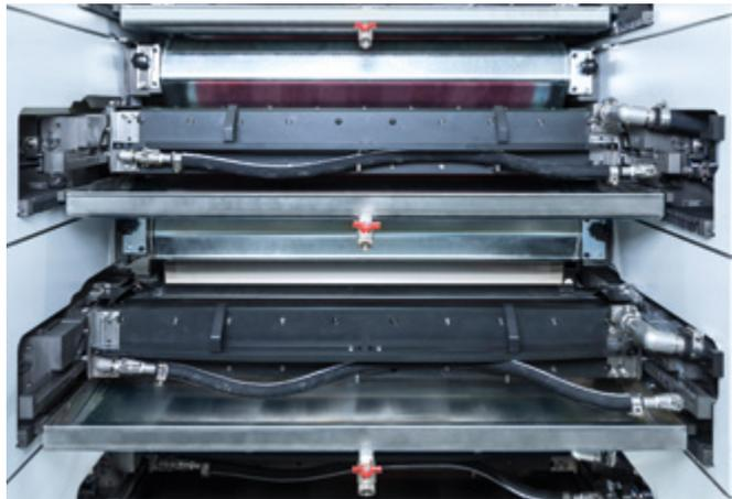
Una struttura solida con spalle laterali in acciaio da 100 mm ed una eccezionale stabilità come standard.
