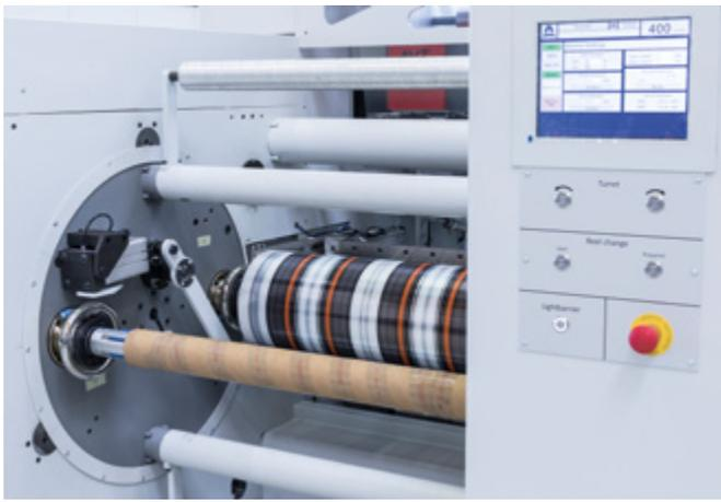
Avvolgitori a torretta: altamente produttivi grazie alle giunzioni completamente automatizzate con velocità di produzione fino a 400 m/min.
