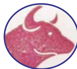
Qualità di stampa dopo 1 ora e 45 minuti con medium PE tape, senza regolazioni aggiuntive.
